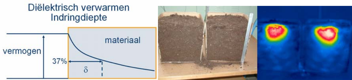
Figuur 2 Schematische weergave vermogensverdeling in de grond (links), foto opwarming vochtige potgrond, indringdiepte maximaal 5 cm (rechts)
