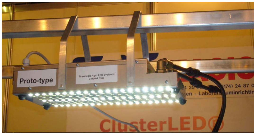
Figuur 3.4 Prototype van watergekoelde ClusterLED® van FlowMagic
