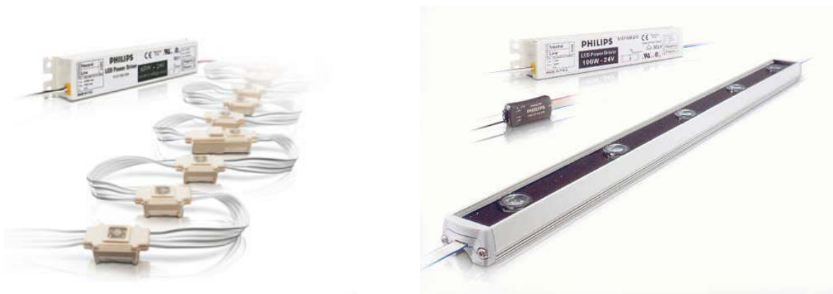
Figuur 3.6 GreenPower LED-string LF (links) en GreenPower LED-module HF (rechts) van Philips (foto Philips). De LED-modules/strings hebben in principe geen extra koeling nodig. Een HF-module met (5) diep-rode LEDs geeft typisch 10 \mu\text{mol/s} bij een vermogensconsumptie van 10 W_e en heeft daarmee een modulerendement van circa 1 \mu\text{mol/s/W}_e . De LED-string geeft per meter (10 LEDs) 3,6 \mu\text{mol/s} bij een vermogensconsumptie van 2,4 W_e en heeft daarmee een stringrendement van circa 1,5 \mu\text{mol/s/W}_e (PHILIPS, 2008)
