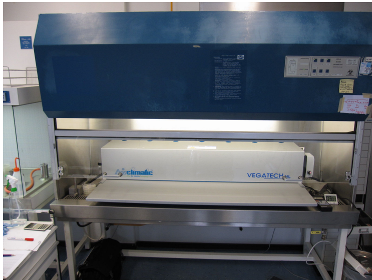
Figuur 1. UV-belichtingsarmatuur in flowkast.
