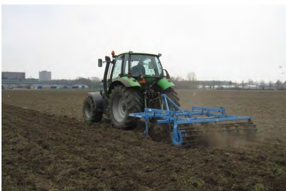
Figuur 3. Niet-kerend, vastetandcultivator met vleugelscharen.
