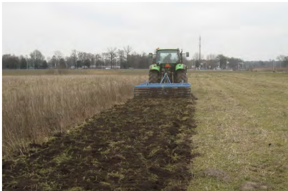
Figuur 6. Ondiepe bewerking op vaste grond met vastetandcultivator met vleugelscharen.
