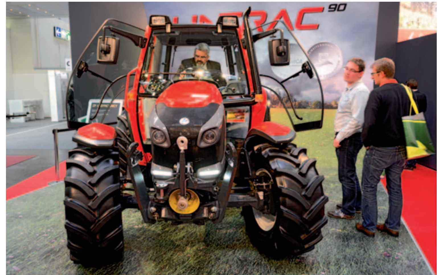
De nieuwe Lindner Lintrac heeft een cvt, vierwielbesturing en een laag zwaartepunt, geschikt voor werk in de bergen dus, of voor gebruik op het talud.
