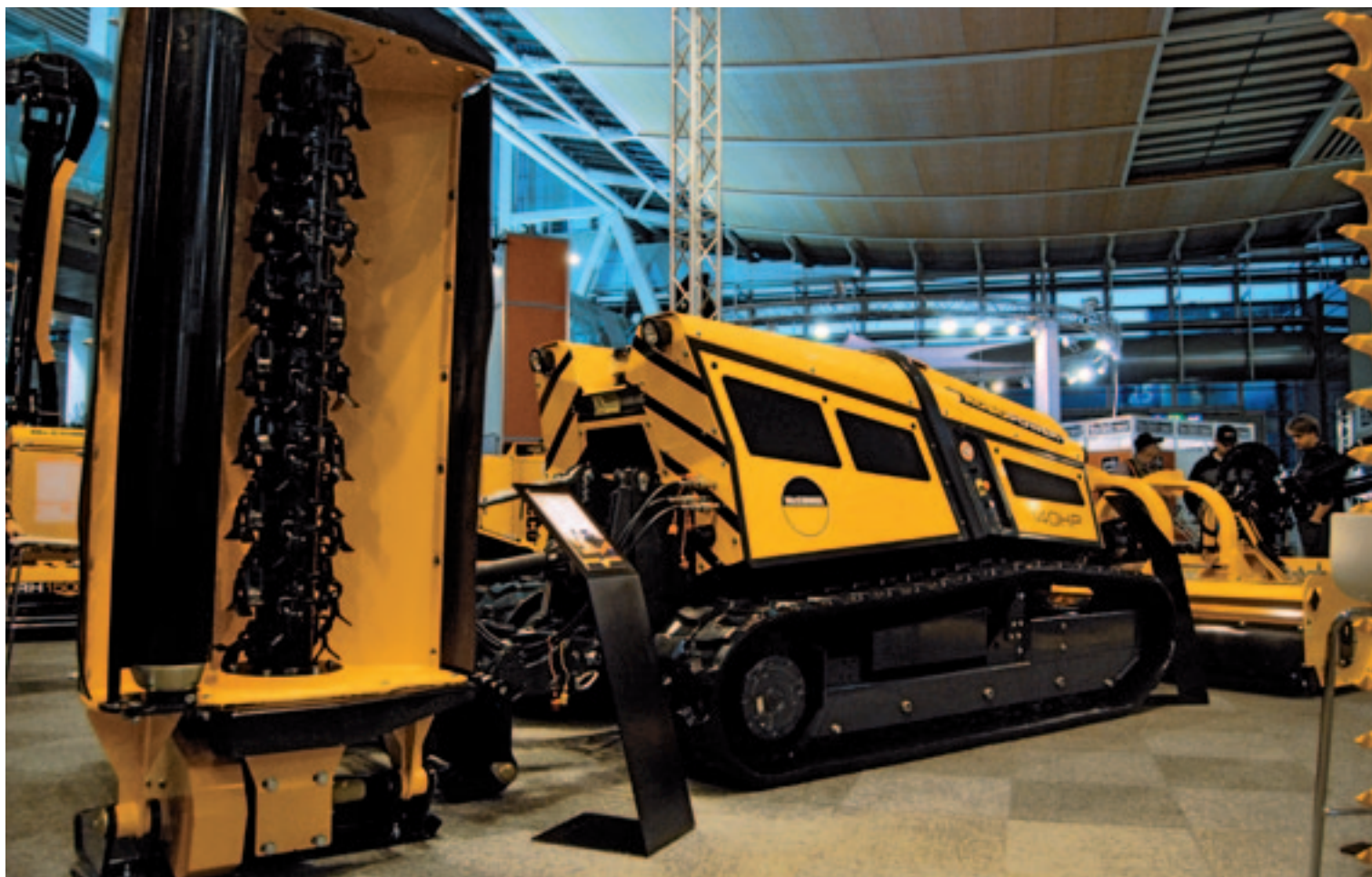
Het meest verrassend op de Agritechnica was de enorme Robopower van het Engelse McConnel met een 105 kW (140 pk) Deutz-motor.
