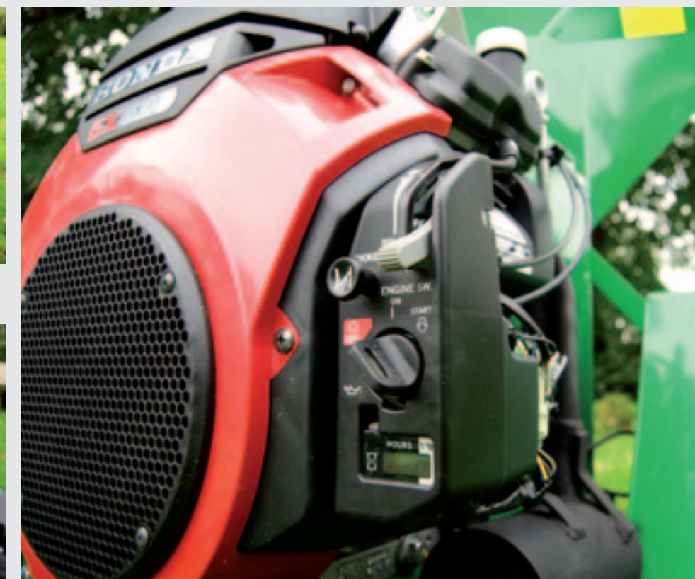
De benzinemotor van de C21 is een tweecilinder van Honda. De motor heeft een urenteller en start elektrisch. Alle bediening, inclusief choke en de gashendel, is netjes bij elkaar gebracht.
