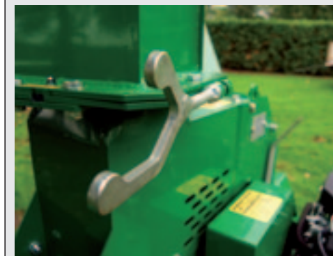
De pijp draait 360 graden en borg je met een spindel.
