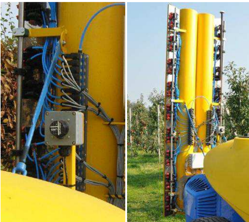
Figuur 10 Het CDS-systeem op de KWH D-1000 fruitteeltspuit (links) en de laserscanner op de CDS-spuit (rechts).
