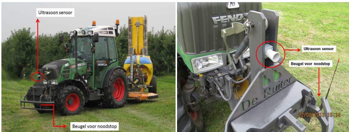
Figuur 7 Veiligheidssysteem met ultrasoon sensor en beugel voor noodstop opgebouwd op de voorkant van de autonome trekker.
