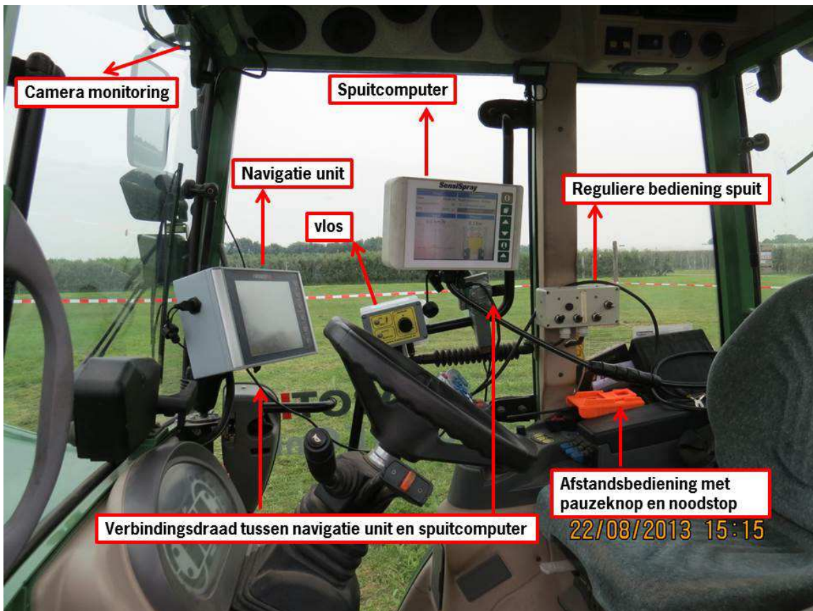
Figuur 4 Verschillende onderdelen opgebouwd in de cabine van de trekker.
