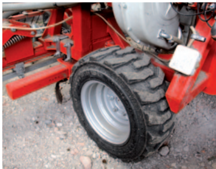
▲ Gebruiker Schieman paste zelf het wielensstel aan op zijn machine, zodat de loopwielen op 1,50 meter spoorbreedte staan.
