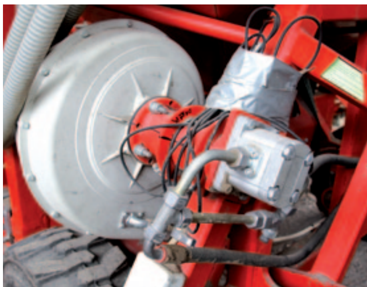
▲ Optioneel wordt de blazer hydraulisch aangedreven. Op het Pro-model is dit standaard. Aansturing via load sensing is optioneel mogelijk.
