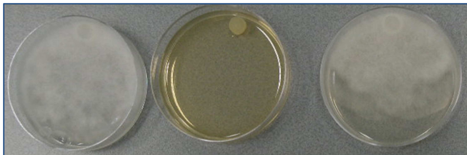
Figuur 5-1 Petrischaal labtoets met Pythium ultimum ; controle (links), 0,5% (midden) en 0,1% tomatenloofextract (rechts).
