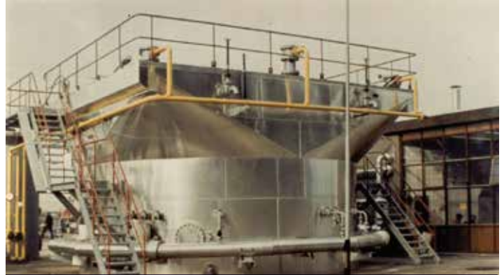
UASB-proefinstallatie bij CSM in de jaren '70. De WVO heeft een belangrijke aanzet gegeven voor het ontwikkelen van de UASB reactor.
