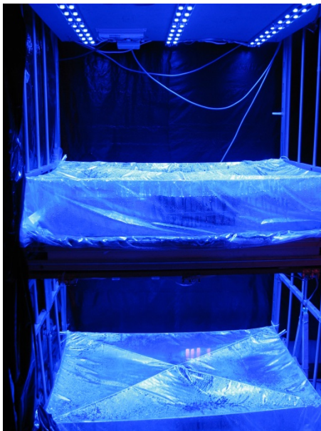
Figuur 1. De proefopstelling met 100% blauwe LED's op een VBA-kar met twee teeltlagen.
