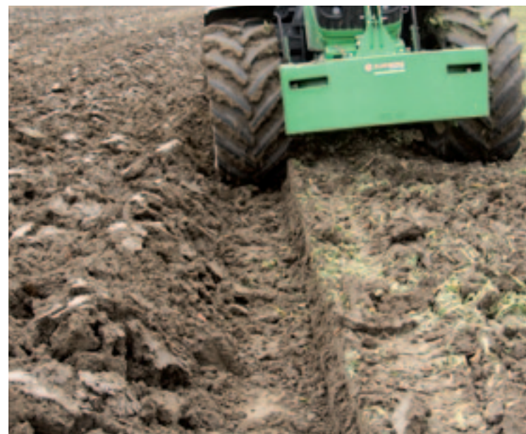
▲ Gebruikers roemen de brede voor van zowel het 46 W als het 27 W-rister. Ploegen met een 65 cm brede band is zo mogelijk.
