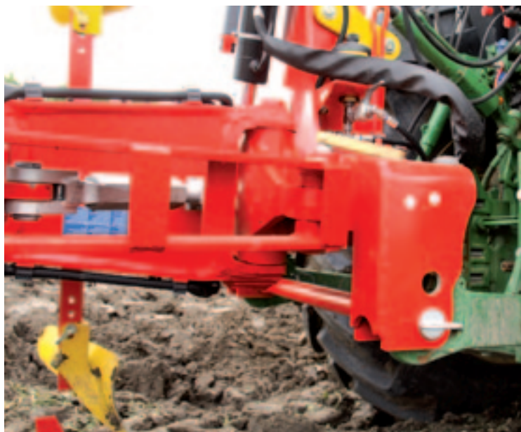
▲ In de S-uitvoering heeft de Servo een verzwaaarde kop. Dit betekent dat de aanspanningspunten voor de hefarmen zijn verstevigd.
