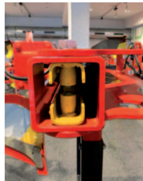
▲ De optionele aanschroefprofielen in de kokerbalk verstevigen het frame.
