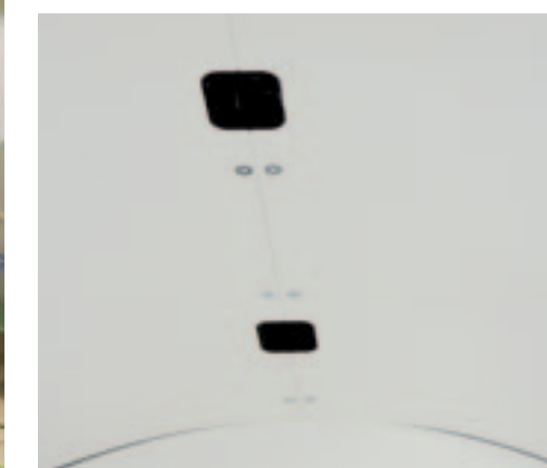
▲ De koepel met camera's is afgesloten. Zo krijg je een zo homogeen mogelijke lichtverdeling.
