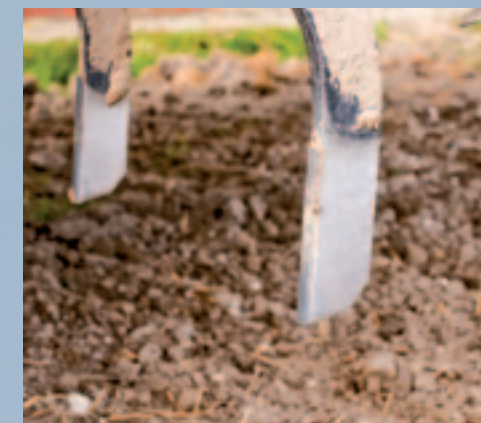
▲ De woelpootjes maken een drainagekanaal van circa 10 cm diep. Dat voorkomt dat het zaad gaat rotten na veel neerslag.
