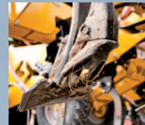
▲ Achter de ganzevoet zit de zaaduitloop met twee kanalen. Daardoor wordt het zaad over een breedte van 10 cm verspreid.
