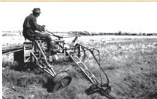
De maaibalk met gebogen uiteinde van Wissekerke is nieuw op de demo in Griendtsveen. Met de machine wordt behalve het talud ook een deel van de slootbodembemaaid. De mesrug in het eindstuk is zeer buigzaam.
