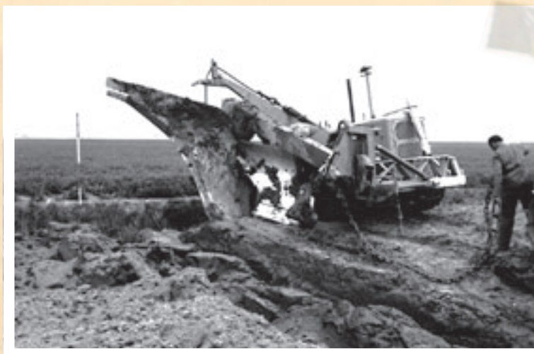
Grondverbetering met een diepploeg aangebouwd aan de zijkant van een Cat D6. De ploegdiepte is 175 cm. De bovenste laag wordt met de voorschaar onderin gebracht en daarna afgedekt met klei uit de ondergrond. De ketting voor een tweede rupstrekker wordt hier uitgelegd.
