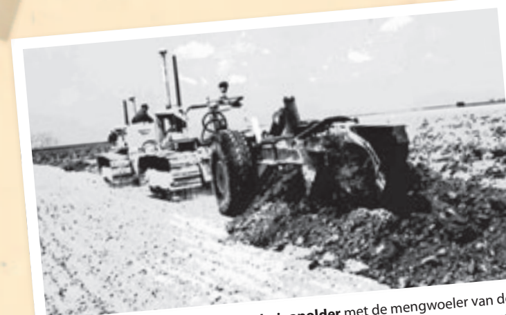
Profielverbetering in de Wilhelminapolder met de mengwoeler van de firma Van Damme. Door de laag zware zavel (30-35 cm dik) te mengen met eenzelfde dikke laag lichtere grond daaronder wordt de bewortelingsdiepte vergroot en daardoor neemt het risico op verdroging af. Met twee Cat D8-rupstrekken werd in een uur 59 are bewerkt.
