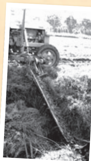
De zelfrijdende taludmaaier van Berkenheger kan werken op smalle schouwpaden. De beide achterwielen worden aangedreven. Het maaigedeelte bestaat uit een 1,50 meter brede dubbele messenbalk van Busatis.
