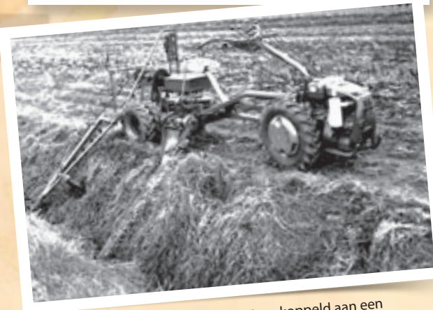
De Wibo-maaiharkcombinatie is gekoppeld aan een eenassige trekker en is inzetbaar op schouwpaden van ruim 1 meter breed. De werkende delen zitten beide aan het getrokken deel en maken het talud in één trek schoon.
