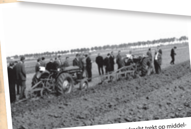
De tweede generatie van de Ford Super Dextra is uitgerust met een 44,5 pk motor, 5 pk meer dan de eerste versie. De mechanische reguleerder past het toerental onmiddellijk aan aan de belasting.
