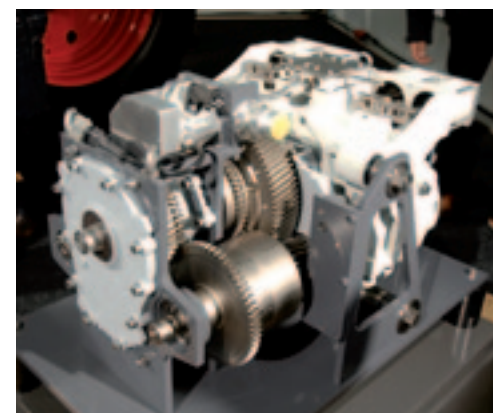
▲ De opengewerkte EQ200 met onderin op de voorgrond het huis van de dubbele koppeling.
