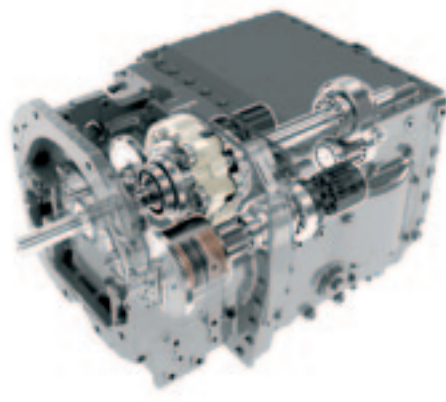
▲ De Cmatic EQ200 van Claas in doorkijkversie. Het dubbele planetair zit links in het midden.
