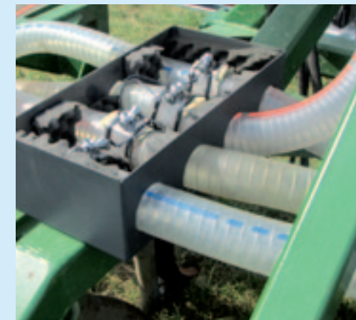
Controleren van de mestdoorstroom In samenwerking met de Hogeschool van Osnabrück, gaat machinefabriek Josef Kotte de doorstroom van vloeibare mest in de slangen van de injecteur controleren. De Flowcheck-sensor zorgt voor een geluidssignaal als in één van de slangen de doorstroom stopt. Ledlampjes geven aan welke slang de boosdoener is.
