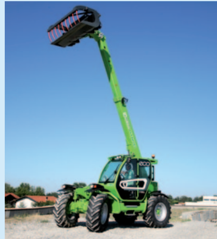
Verreiker aan het stopcontact Merlo gaat op de Toyota-tour en komt met een hybride verreiker. Die heeft een grote accu die wordt geladen door de dieselmotor die – als hij draait – op een constant toerental loopt. Heb je weinig vermogen nodig, dan rij je emissievrij en geluidsarm. Het vermogen van de dieselmotor is gehalveerd. Dit in combinatie met de deels elektrische aandrijving, moet zorgen voor een 30 procent lager dieselverbruik. Wie het systeem aan de gang wil houden moet de accu wel 's nachts aan de lader leggen.
