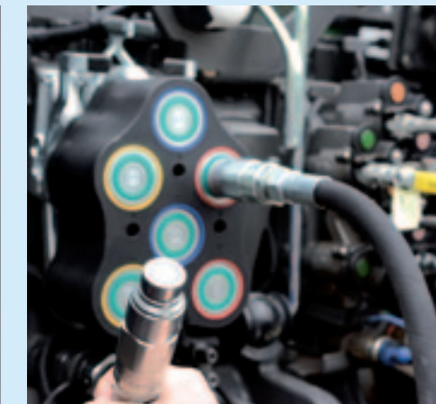
Flat Face-koppeling Fendt is het beu, en dat werd tijd. Hydrauliekslangen aansluiten wordt stukken makkelijker met de Flat Face-koppeling die Fendt laat zien op de Agritechnica. Aankoppelen gaat met één hand, afkoppelen met twee vingers dankzij hendeltjes die de druk van de ventielen halen. Bovendien zorgt Flat Face voor meer doorstroom en minder lekkage.
