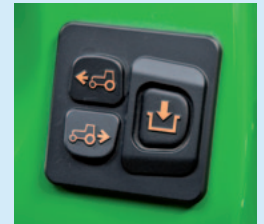
Nog meer knopjes op het spatbord Op het achterspatbord van John Deere, vind je in de toekomst nog meer knopjes. Niet alleen voor de hef, de aftakas en de hydrauliek, maar ook om compacttrekkers met een hydrostatische aandrijving bij het aankoppelen voor- of achterwaarts te laten rijden. Het systeem werkt ook als de trekker op een helling staat, omdat hijzelf de handrem eraf haalt.
