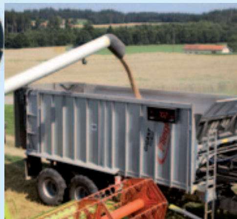
Weegstelsysteem via de isobusterminal Wegen met de transportwagen staat in de belangstelling, meent Fliegl. Bijvoorbeeld bij de oogst, bij het kunstmest strooien of bij het verspreiden van vaste mest. Het Fliegl FWS 2014-weegstelsysteem voldoet aan de isobusstandaard en kan dus bediend en afgelezen worden via de terminal van de isobustrekker.
