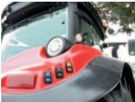
▲ Hef, aftakas en één dubbelwerkend ventiel zijn vanaf het spatbord te bedienen.
