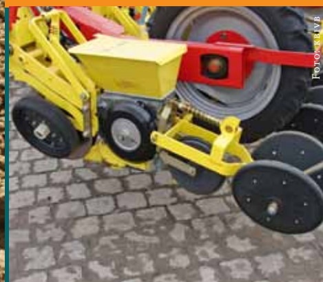
Uitrusting van de Vicon Rau Unicorn voor het zaaien in afgestorven bodembedekkers.
