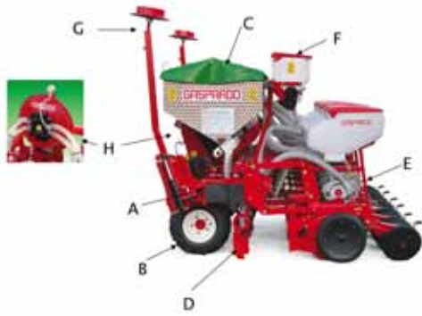
Figuur 1 Bouw van een maïszaaimachine (bron: Gaspardo-Agropak)
