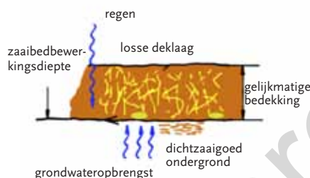
Figuur 2 Schematische voorstelling van een ideaal zaaibed
