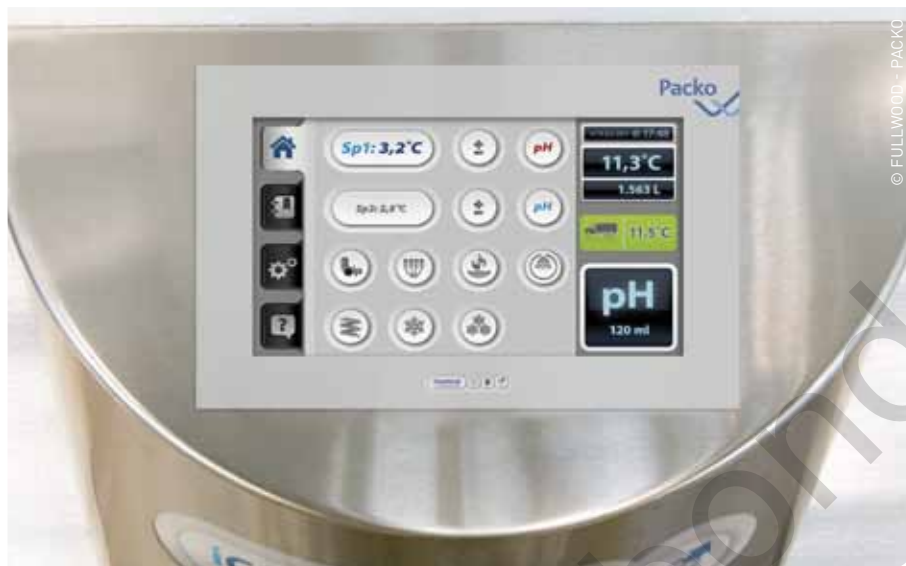
iControl, de nieuwe melkkoeltanksturing van Packo Inox.
