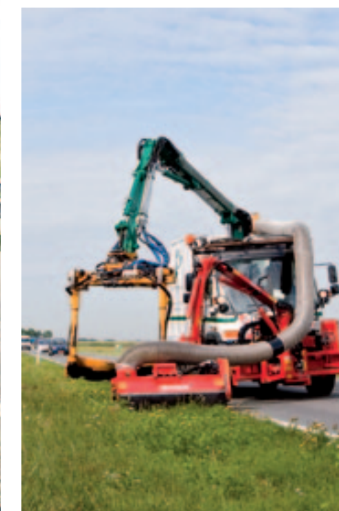
De Unimog heeft alles in huis om goed overweg te kunnen met een maaiaarm en kan geleverd worden met een kenteken voor vrachtverkeer. De motoren voldoen aan de Euro 6-emissienorm.
