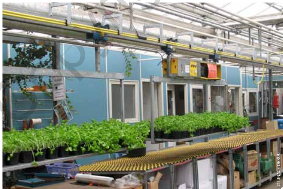
Het intern transport van de planten in de serre gebeurt via een railsysteem dat in de serre hangt.
