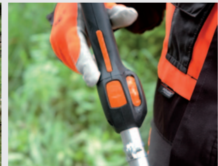
Met Eco-speed (de draaiknop rechts) is het maximumtoerental in te stellen, terwijl je de handgashendel volledig kunt indrukken.
