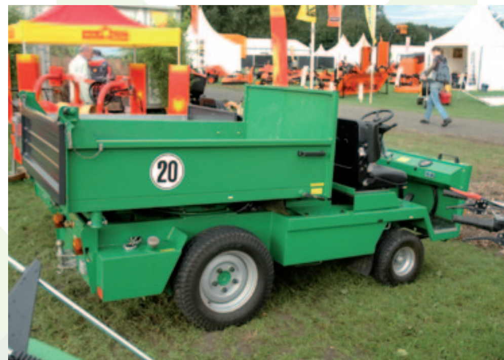
Schmitz Gartenbaumaschinen & Transportfahrzeuge uit Duisburg stond op de GTH met deze MK; die afkorting staat voor Mini-Kipper. Als 1702 heeft hij een 13,2 kW (18 pk) tweecilinder dieselmotor. Bij de 1703 is dat een 19,1 kW (26 pk) driecilinder en bij de 1704 een 26,5 kW (36 pk) viercilinder. De draaglast voor die drie typen bedraagt respectievelijk 1.200, 1.300 en 1.500 kg. De lengte van de MK blijft in alle drie gevallen beperkt tot 304 cm en de breedte tot 115 cm. De aandrijving van de achterwielen is hydrostatisch. Als MK 1700 E is de Schmitz ook verkrijgbaar met elektro-aandrijving via vijf loodaccu's met 48 volt en een capaciteit van 320 Ah. Het draagvermogen is dan 1.000 kg.
