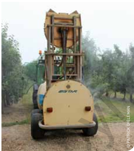
Op deze spuit werden links driftreducerende luchtmengdoppen gemonteerd. Je kan er de spuitnevel veel minder goed zien dan rechts, waar klassieke doppen gebruikt worden.
