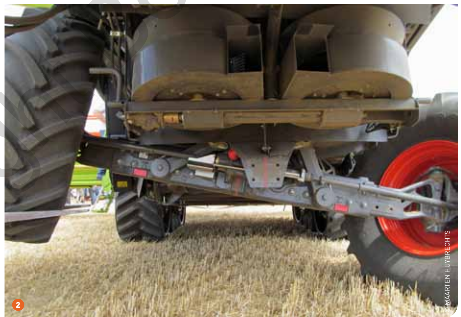
1 Het systeem Terra Trac heeft dankzij de nieuwe vering nu 3 onafhankelijke steunpunten: het loopwiel, de tussenunit en het aandrijf wiel. 2 De achteras heeft een stangenophanging met 4 scharnierpunten. Dit laat onder meer het monteren van grotere wielen toe.
