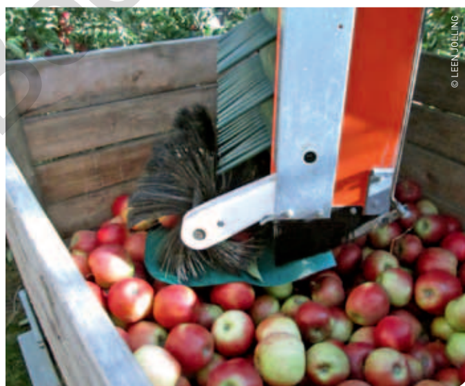
Het fruit komt via een transportband in een draaiende pallox terecht, waardoor het fruit gelijkmatig verdeeld wordt.
