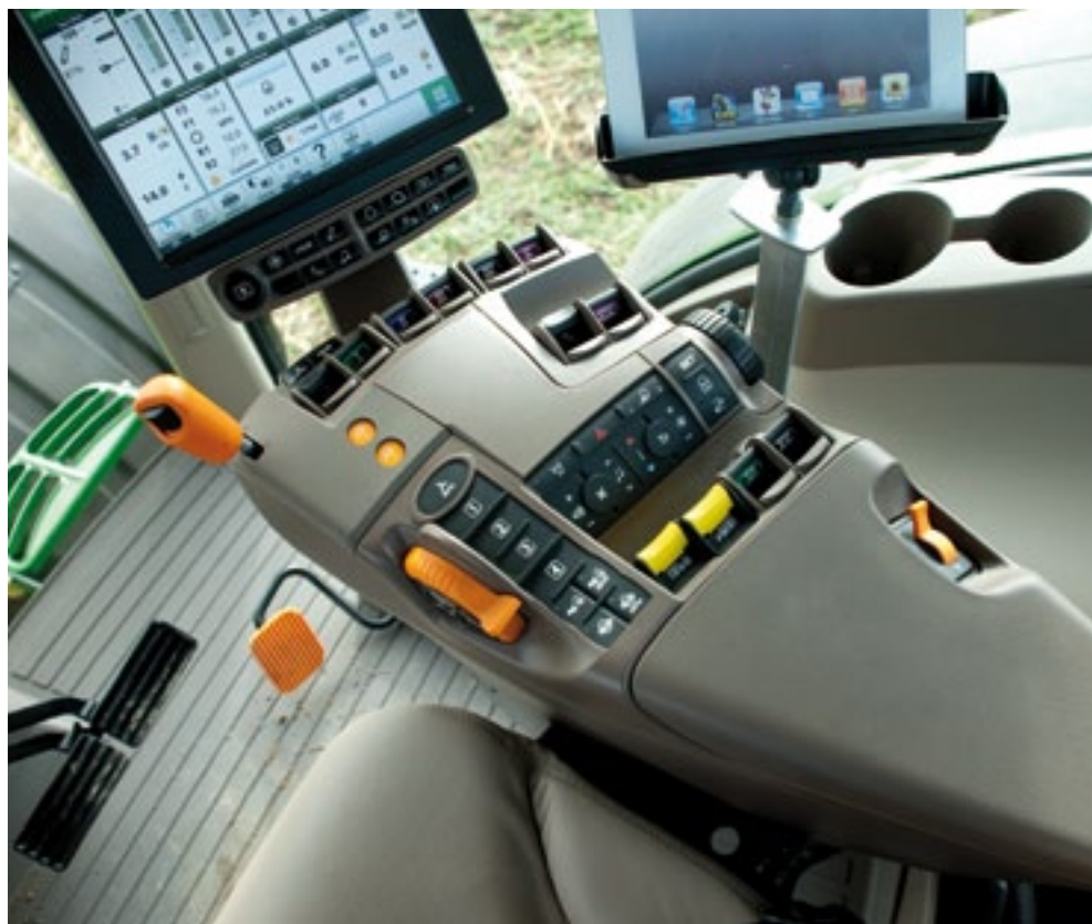
▲ De bediening in de armleuning is gerangschikt op functie.
