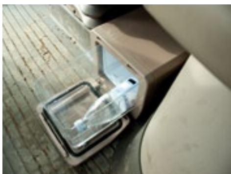
▲ Linksonder de zitting heeft John Deere een koelkast ingebouwd.
