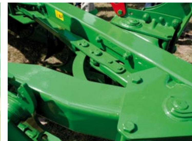
▲ Het ijzerwerk voor de variobreedteverstelling loopt niet over en onder de ploegboom langs, maar dwars door de ploegboom heen.
