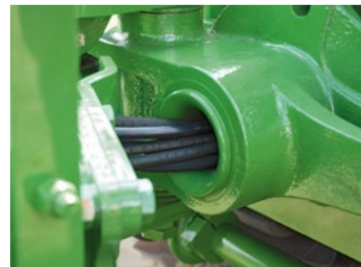
▲ De hydrauliekslangen voor de varioverstelling lopen keurig door de driepuntsbok heen. De kans dat de slangen hier beschadigd raken, is gering.
