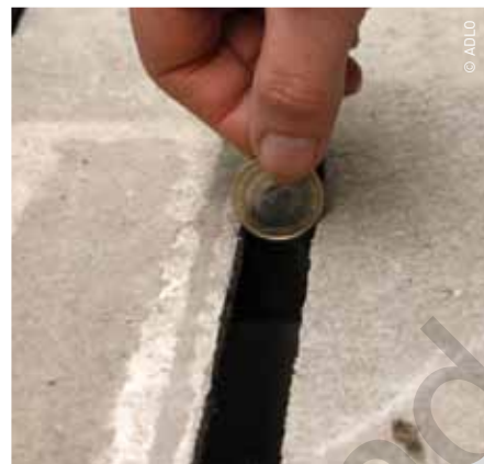
Test de spleetbreedte van een zeugenrooster met een stuk van 1 euro.
