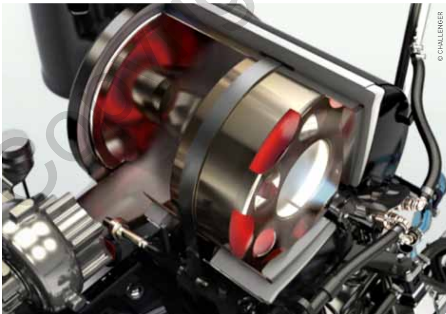
De DOC-filter houdt de deeltjes tegen en elimineert de CO.
