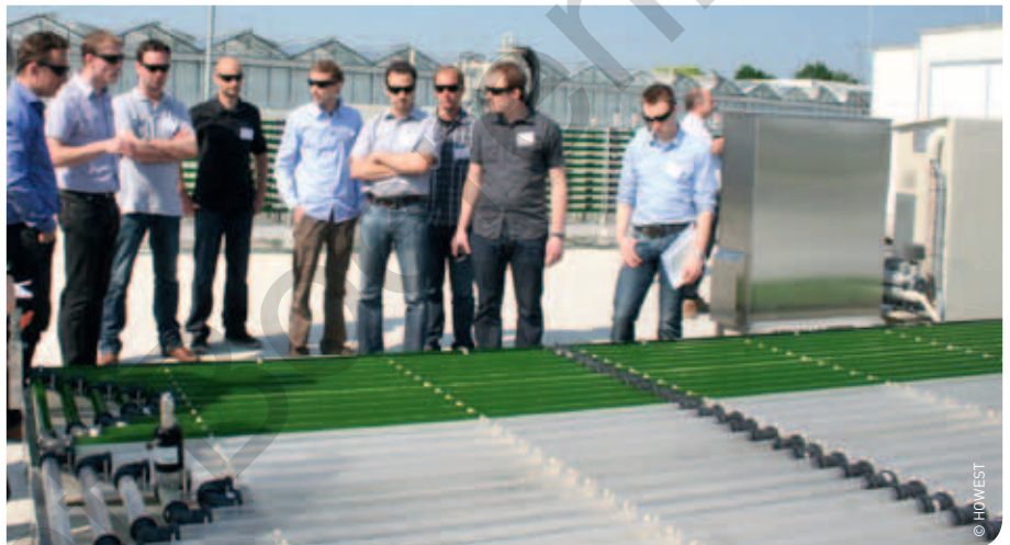
Op het onderzoekscentrum AlgaePARC bevinden zich deze gesloten horizontale fotobioreactoren voor microalgenteelt (zie pagina 38).
