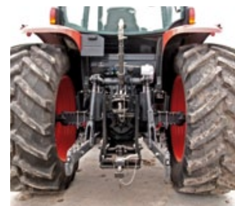
De 650/65R38 banden steken ver buiten de spartborden uit. Verbreders zijn leverbaar. De hefkracht is gemiddeld.
