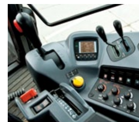
De groepenpook heeft twee neutraalstanden en herbergt ook powershiftknopjes.
