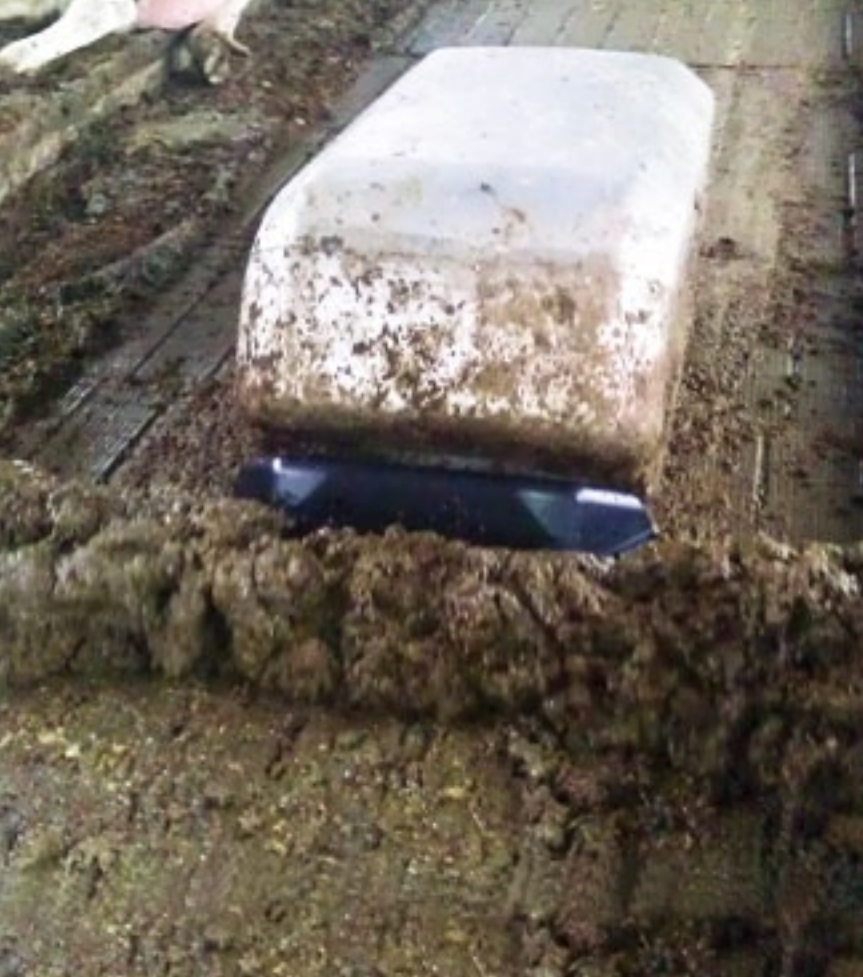
Een crisissituatie. Te veel mest hoopt zich op voor de schuif. De emissiearme vloer is niet meer schoon te krijgen.
