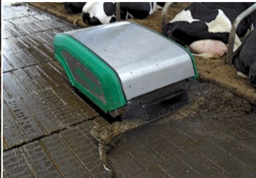
Door een watersproeier op de mestrobot te installeren – onder de boxachterwand is ook mogelijk – blijft de capaciteit van de robot op peil.
