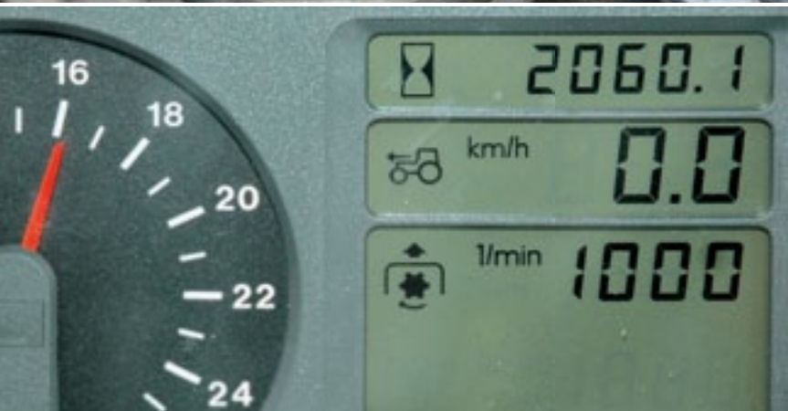
Mechanisatiebedrijf Haank bouwde voor veehouder Ten Arve de Sauter-frontaftakas om tot een eco-versie. In de cabine is af te lezen dat het aftakstoerental van 1.000 bij een laag motortoerental wordt bereikt.
