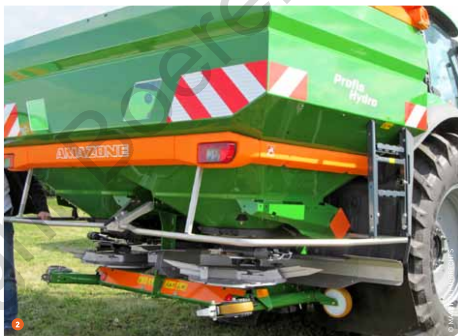
1 De Cirrus heeft in zijn versie 03 een aaneengesloten rij matrixbanden. Hierdoor wordt de bodem op een specifieke wijze aangedrukt. 2 Amazone levert ook strooiers met hydraulisch (later elektrisch) aangedreven strooischijven. Hiermee kan de strooibreedte worden aangepast.
