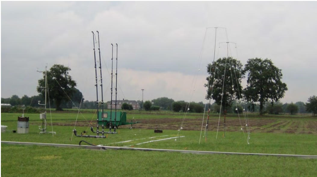
Figuur 2.4. Overzicht meetopstelling in het veld; links meteomast, midden twee driftmeetmasten met actieve aanzuiging op 5 m en 10 m van de dop en rechts twee masten op 5 m en 10 m van de dop met passieve collectoren; daartussen de twee meetstroken met collectoren voor de driftdepositie op de grond en op de voorgrond de rails waarover de enkeldopsbespuiting uitgevoerd wordt.
