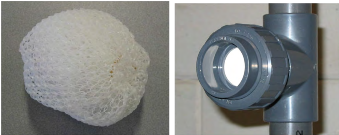
Figuur 2.5. Passieve collector (links) en actieve collector (rechts) voor het meten van de drift in de lucht.
