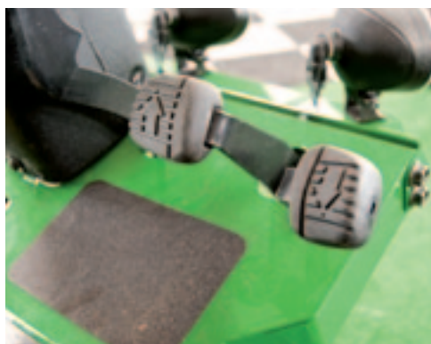
Henk Loomans prijst de niet-scharnierende pedalen: "Bedienen vanuit je enkels is tergend."
