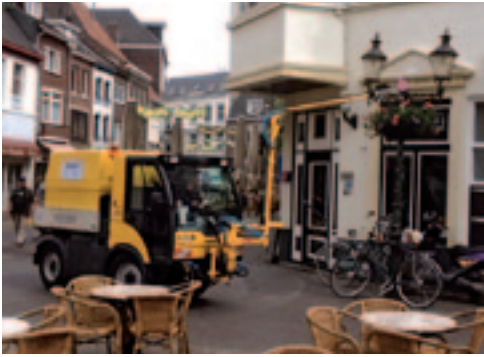
Hako levert een gietarm die bijvoorbeeld op de Multicar kan worden gemonteerd. Het bereik van de arm is 4 meter, al zijn ze ook leverbaar met een bereik van 6 meter.
