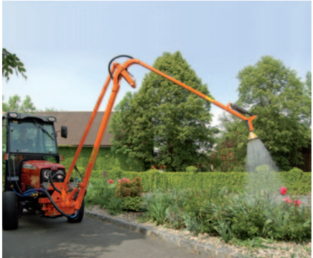
Vanderhaeghe importeert de Eco-gietarm uit Oostenrijk. De gietarm die 160 graden kan draaien, kost inclusief hydrauliekblok ruim 5.500 euro.
