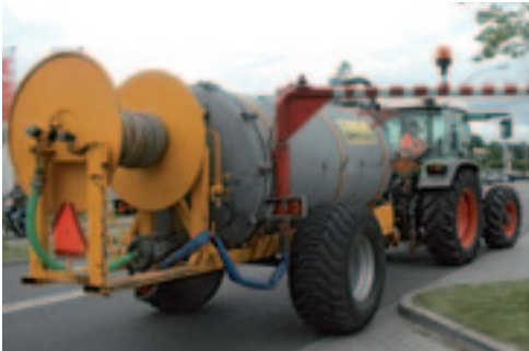
Gemeente Almelo heeft zelf een hydraulisch bediende arm gemaakt. Achterop de tank is een slanghaspel gemonteerd voor als de tank niet dicht genoeg bij de bomen kan komen.
