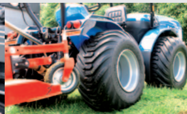
De knikbestuurde AR pendelt over de knik. Daardoor blijven de wielen ook in heuvelachtig terrein altijd aan de grond.
