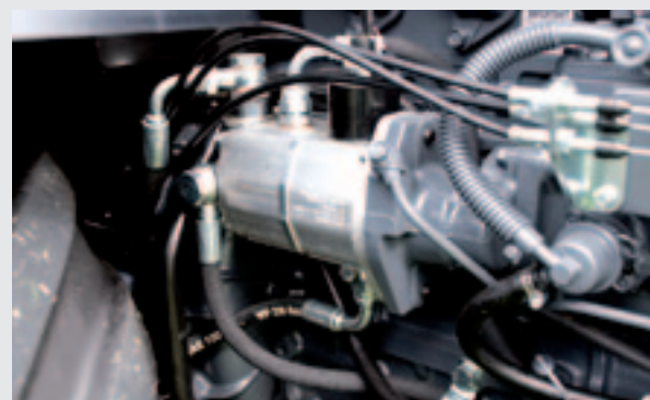
De Invictus K600 heeft twee hydrauliekpompen. Een voor onder meer het sturen, de ander voor de externe hydrauliek.
