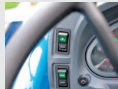
Met een tuimelschakelaar zet je de aftakas in het werk. Voor het wisselen van het toerental, moet je van de trekker af.
