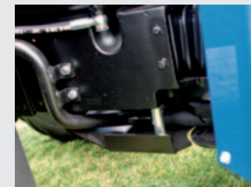
Kwetsbare onderdelen, zoals hydrauliekslangen, zijn bij de Invictus K600 netjes afgeschermd.
