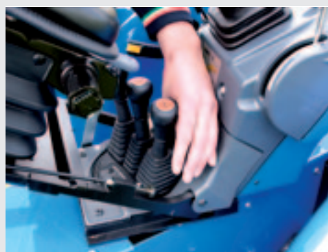
Het omkeren van het bestuurdersplatform is eenvoudig. Kwestie van ontgrendelen, draaien en weer vastklikken.
