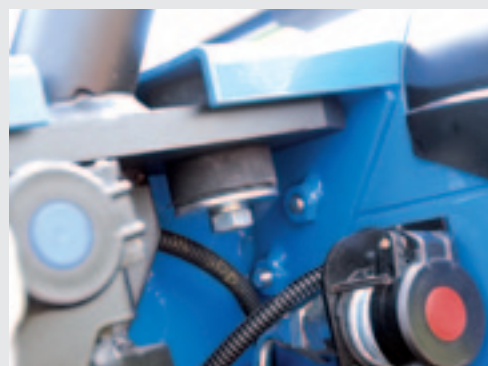
Het bestuurdersplatform rust op rubberblokken. Daardoor worden de trillingen vanuit de achterbrug gedempt.
