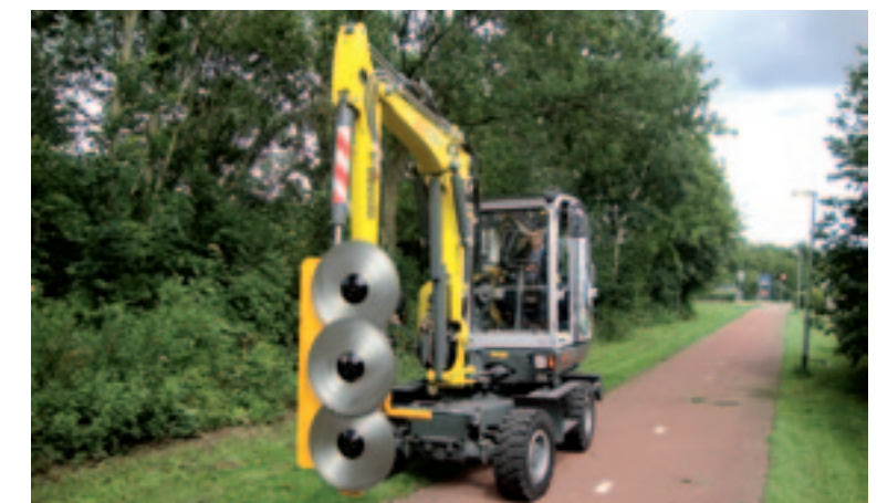
De driedevoudige Power-cirkelzaag aan een hydraulische arm van een mingraver.
