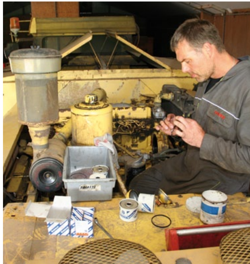
▲ Terwijl de familie Van der Waal met een vervangende Claas-maaidorser bloemzaden aan het dorsen is, klimt monteur Harm Coppens boven op hun New Holland 8060 uit 1982. Dat is even andere koek dan de nog vrij nieuwe Lexion waaraan hij even daarvoor nog sleutelde. Maar dit soort klussen heeft zijn charme, vindt Coppens. De brandstofpomp heeft het begeven door gebrek aan smering. Bij deze oude Ford-zcilinder gebeurt dat niet automatisch. Een nieuwe brandstofpomp vinden, viel niet mee. Maar via dieselspecialist Terlouw uit Mijnsheer-land heeft Van Gemeren een gereviseerd Engels exemplaar op de kop kunnen tikken. Na het omzetten van een tandwiel – het nieuwe exemplaar had de tanden onder een hoek van 30 graden staan terwijl die van de oude recht zijn – zit de pomp al snel weer op zijn plek. Coppens had de motor al voor het demonteren op tijd gezet. Dat wordt beloofd: de motor draait meteen soepel.
