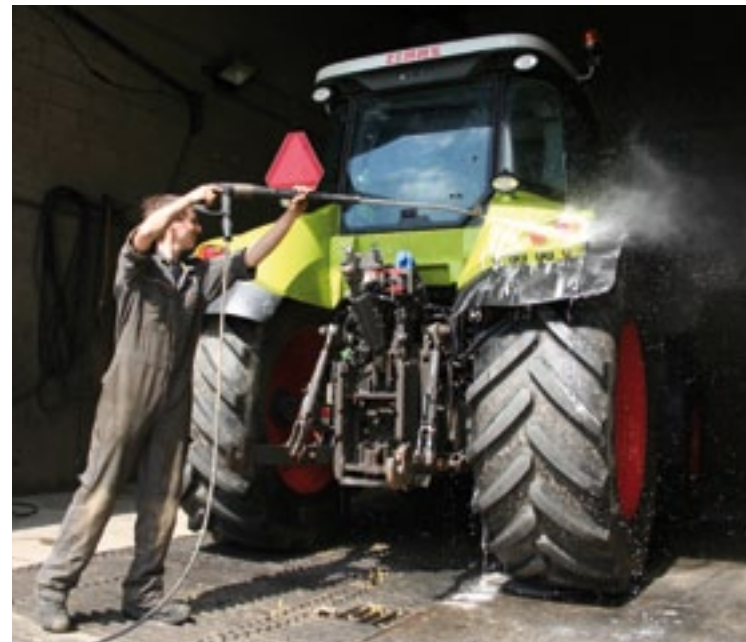
▲ Stefan Suikerbuik monteert na de grote beurt van deze Claas Arion 620 de stabilisatiestangen van de hefarmen, die hij vrij van roest heeft gemaakt. Ze draaien nu weer soepel. Nog even afsproeien en dan is de trekker weer tip top in orde. De inruiler is in stappen onder handen genomen, zodra er even tijd over was in de werkplaats. Ook was de trekker regelmatig even weg, onder andere voor de graandemonstratiedag in Westmaas en een open dag van Amazone. Komende herfst gaat de Arion in de verhuur bij het loonbedrijf dat hem heeft ingeruild.
