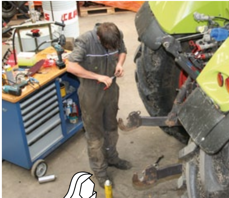
▲ Stefan Suikerbuik monteert na de grote beurt van deze Claas Arion 620 de stabilisatiestangen van de hefarmen, die hij vrij van roest heeft gemaakt. Ze draaien nu weer soepel. Nog even afsproeien en dan is de trekker weer tip top in orde. De inruiler is in stappen onder handen genomen, zodra er even tijd over was in de werkplaats. Ook was de trekker regelmatig even weg, onder andere voor de graandemonstratiedag in Westmaas en een open dag van Amazone. Komende herfst gaat de Arion in de verhuur bij het loonbedrijf dat hem heeft ingeruild.
