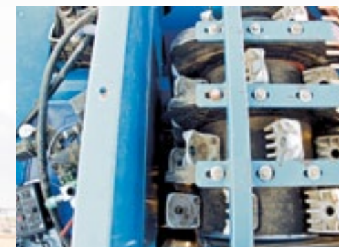
▲ De Standen Pearson-pootmachine is per pootelement voorzien van twee dubbele pootbanden.
