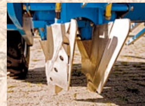
▲ Elk element is uitgerust met twee kouters. De kouters zijn asymmetrisch, zodat de ruimte tussen de kouters niet volloopt.
