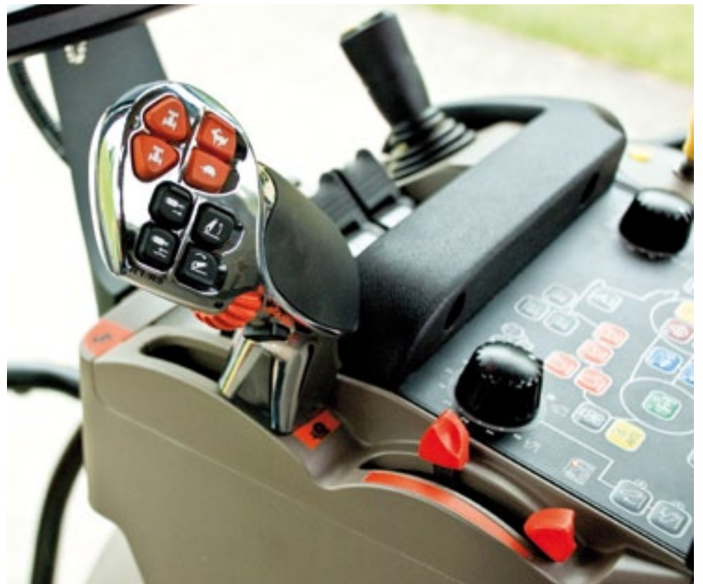
▲ De joystick is grofweg gelijk gebleven, maar heeft nu verlichte knoppen. Bovendien kun je er de rijrichting mee kiezen. Met de oranje draaiknop stel je de doelsnelheid in.
