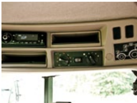
▲ In de cabine is het klimaatmanagement van linkerachterstijl naar rechtsboven verhuisd.
