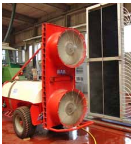
Indoormetingen op het ILVO: hier wordt de spuitvloeistofverdeling gemeten.
