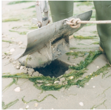
Fig. 2.1. Monstertuigen die worden gebruikt bij de kokkelinventarisatie (links het kockelschepje, rechts de stempelkor).
