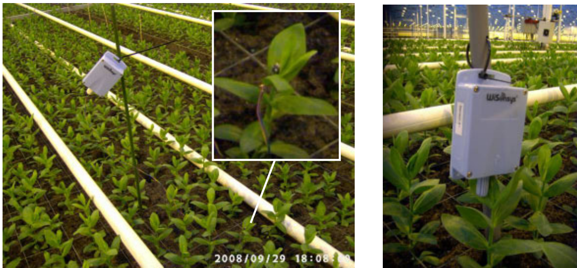
Figuur 2. Sensoren temperatuur en RV microklimaat. Links is de sensor tegen het bovenste blad geplaatst. Rechts is de sensor vlakbij het bovenste blad geplaatst. Op de achtergrond is de I4all meetpaal met klimaatsensoren te zien.
