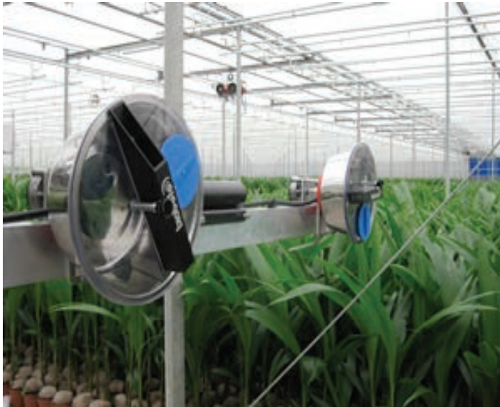
Biobolo, in blauw het vulgat, in zwart de doseerkoker met uitstrooiopening (Foto Arend-Sosef)
