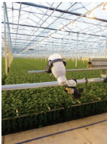
Mite-applicator: rotatiebuis, houder met flesjes met een doseerdop
