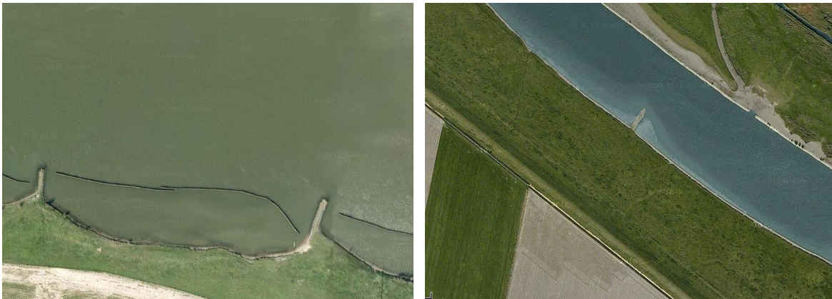
Figuur 3.1. Vooroeververdediging met overlappende openingen (Steenwaard in de Nederrijn/Lek, NL93_7) en openingen die niet overlappen (Zuiderdiep en Bos- en Kroningspolder in het Haringvliet, NL94_11). Bron: GOOGLE EARTH.
