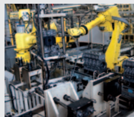
▲ Dertig lasrobots zetten in de Kubota-fabriek in het Japanse Tsukuba motoren in elkaar.
